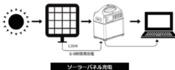
ソーラーパネルから充電も可能で使い方も簡単。スマートフォン、タブレット、ノートパソコンや液晶テレビ等、様々な電化製品・電子機器に使用でき、非常時の不安を解消します。
