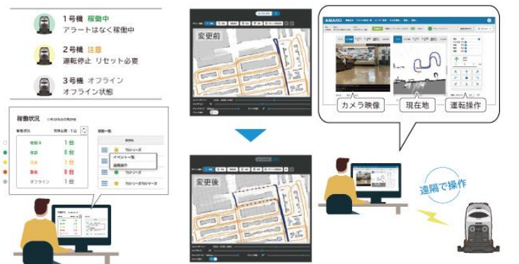
A 複数台数のロボットを一括管理 B 遠隔ルート修正機能 C 自動洗浄時の遠隔操作
