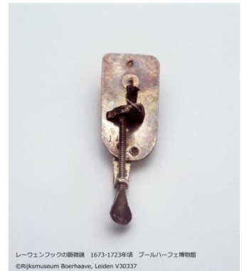
レーウェンフックの顕微鏡 1673-1723年頃 フォルハーフェ博物館 ©Rijksmuseum Boerhaave, Leiden V30337
