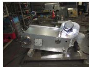
写真⑦・・・「ATFタンク」溶接作業
