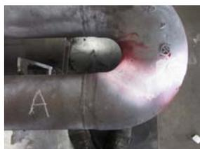
写真③・・・「ラジアントチューブ」修理完了
