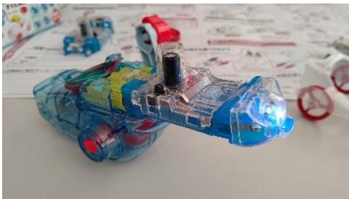
手回し発電機+コンデンサー+発光ダイオードで 蓄電式発電ライト
