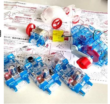
手回し発電機 と 車体 と コンデンサー 豆電球 発光ダイオード ブザー モーター これらを組み合わせて実験する教材です！
