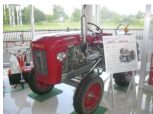
1961年製の空冷4サイクル 2気筒ディーゼルエンジン、 20馬力のトラクタです
