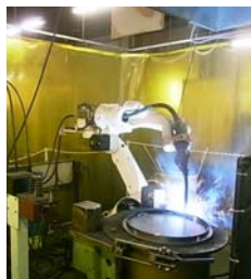
溶接ロボット
